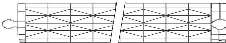
Sistema de paneles modulares de policarbonato extruido, ideal para la construcción de paredes translúcidas verticales y/o inclinadas. El sistema prevé la unión de estos paneles mediante un simple sistema de unión "machihembrado".
