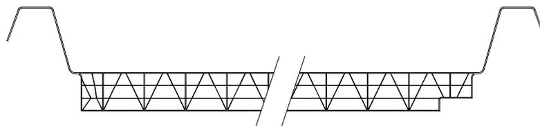
Paneles multicelulares diseñados para su uso en el sector de la construcción industrial. Se utilizan en cubiertas planas en combinación con paneles aislantes de poliuretano o con perfiles de metal corrugado.
